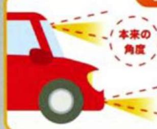
衝突被害軽減ブレーキシステムのレーダーセンサーの取り付け角度が正しい位置に取り付けられていなかった。これに加え、段差を通過した際の車体の上下動により、道路に対し当該システムが反応しブレーキが作動したものと推定される。
