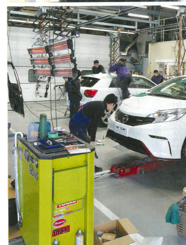
アフターメンテナンスを徹底追求するため、店舗に併設した板金塗装工場。塗装には3年前から水性塗料を導入し、人体や環境にも配慮。
